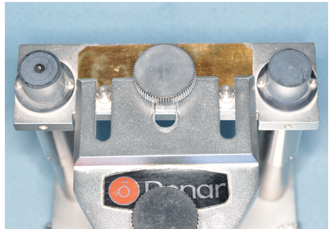
FIG.27 Prima di stampare la ceramica Trebbi pone uno spaziatore da 0,35 mm sotto il membro superiore per rialzarlo. In tal modo compensa il ritiro della ceramica durante la seconda cottura.
