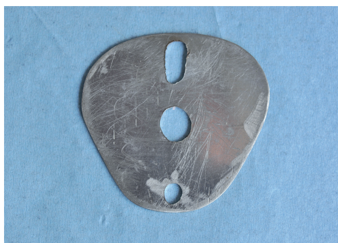
FIG.24 Visione di pianta della piastra, dello spessore di 1 mm, da porre sulla parte inferiore del corelator, sotto il modello.
