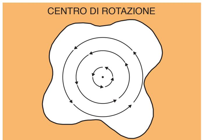
Fig. 35 Rotazione e centro di rotazione in un corpo irregolare.
